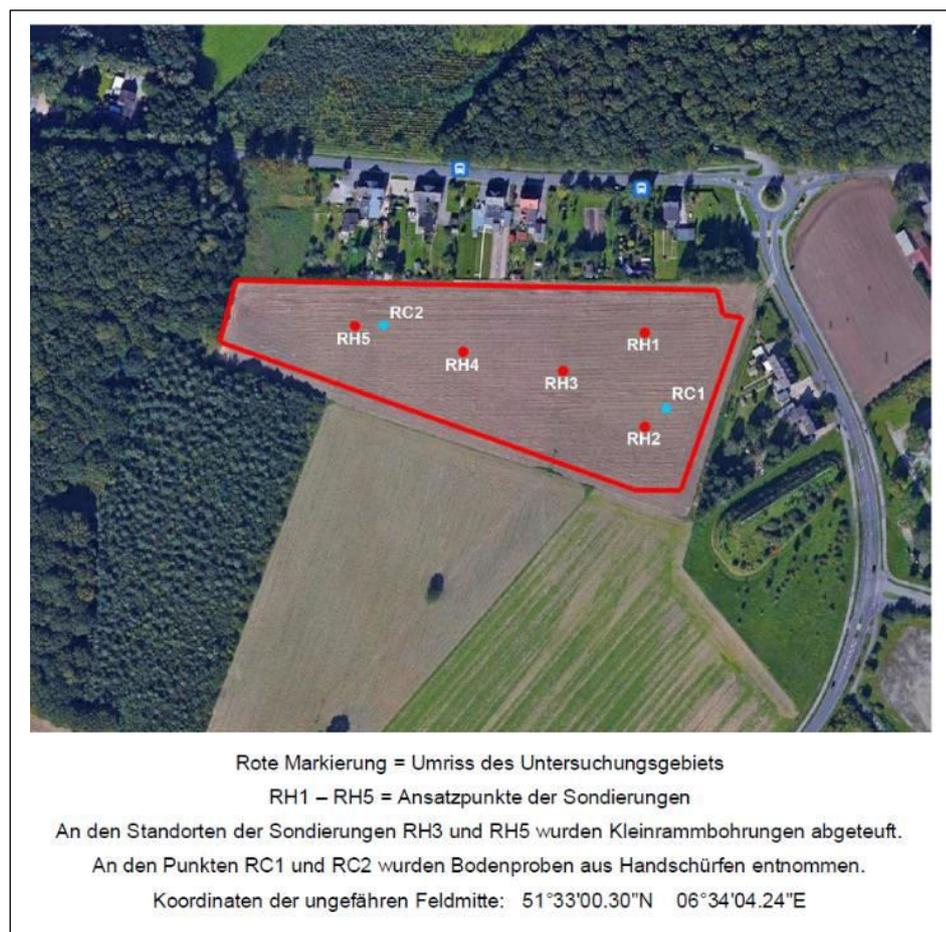
Abb. 20: Lage der Lageplan der Sondierungen o.M. und genordet (Quelle: Gutachten zur Ermittlung der erforderlichen Rammtiefe für Stahlprofile als Gründungselemente, Solarpark Rheinberger Heide; ConSoGeol GmbH, Aichach, 08/2024)
